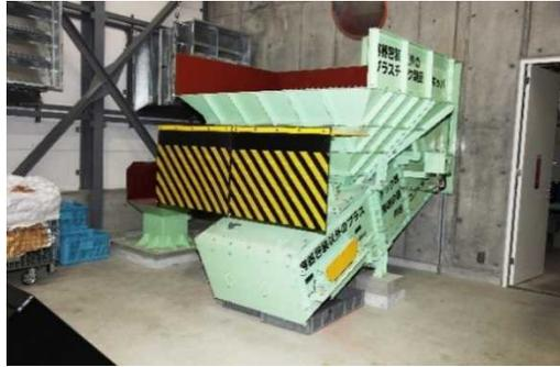
容器包装以外プラスチック類用破碎機
