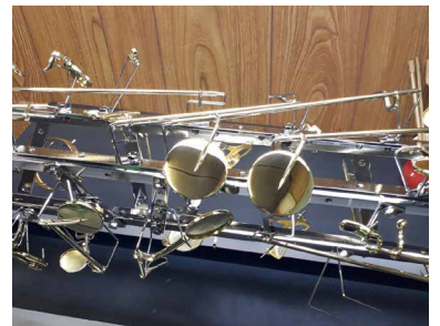
サクソフォン部品のバレル研磨加工例
