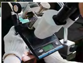
顕微鏡を用いたφ0.5mm以下の金属管内部線材精密溶接加工例
