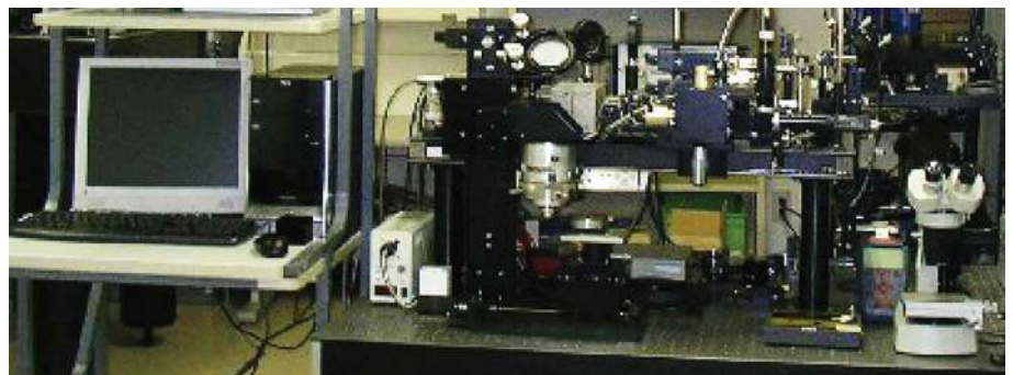
高い分解能を持つレンズやガルバノスキャナー、高精度な自動ステージ等の様々なユニットを搭載した社内の加工実験装置
