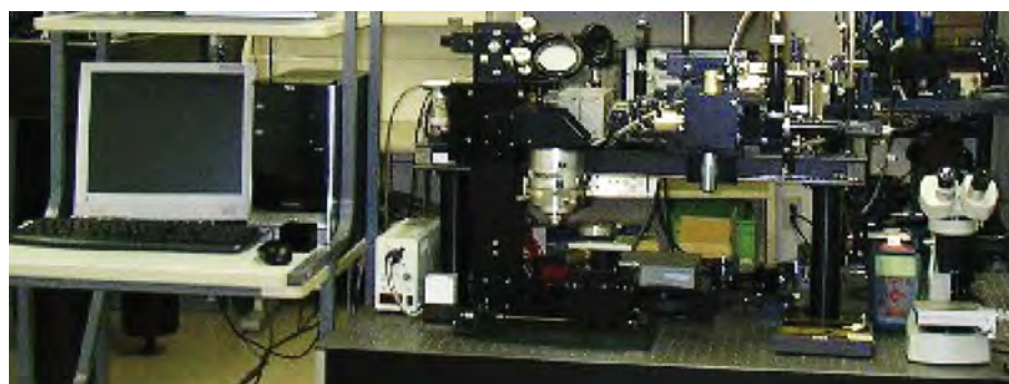
高い分解能を持つレンズやガルバノスキャナー、高精度な自動ステージ等の様々なユニットを搭載した社内の加工実験装置
