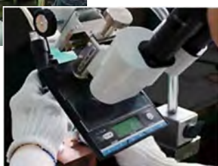
顕微鏡を用いたφ0.5mm以下の 金属管内部線材精密溶接加工例
