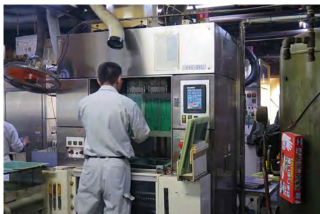
半田レベラー作業
