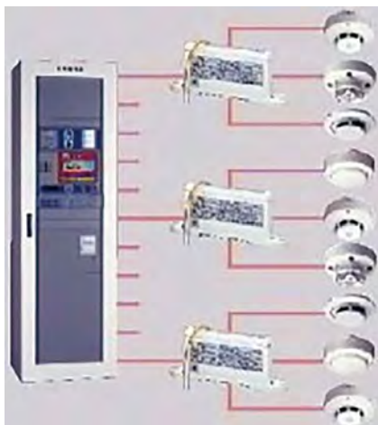
火災報知システム
