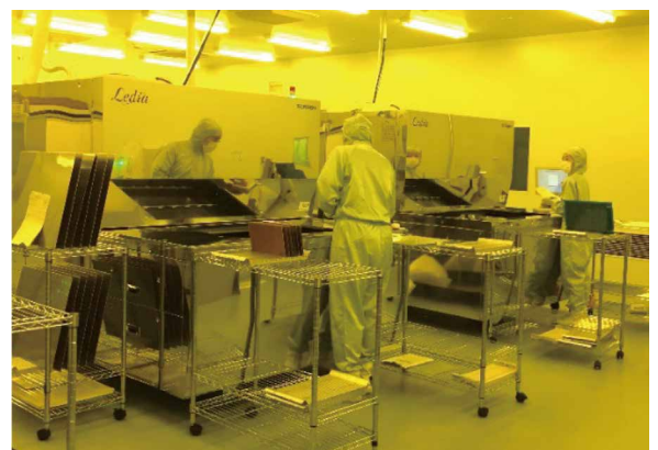
基板のパターンニング工程の様子(配線の焼付作業)
