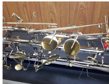
サクソフォン部品のバレル研磨加工例
