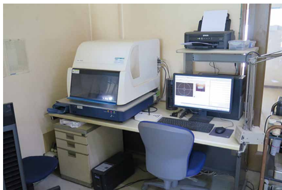
蛍光X線装置による評価分析
