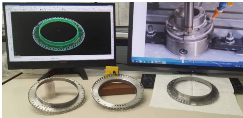
3次元CADによるモデリングと加工製品
