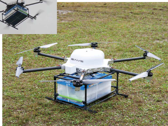
～レベル4を見据え、目視外の有人地帯で安全に飛び交う社会の実現へ～ 搬送先まで完全自動で医薬品コンテナを配送することができる
