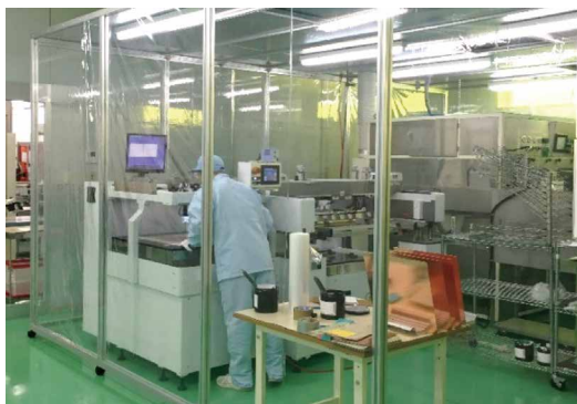
基板のレジスト工程の様子(板の色付作業)
