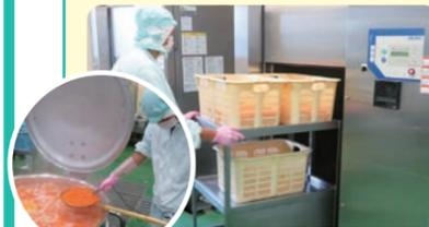
給食で提供されるサラダやあえ物の野菜は、衛生管理のため一度茹でています。茹でたての野菜も真空冷却機で一気に10度以下まで冷やし、ドレッシングなどとあえ、冷たい状態で提供します。
