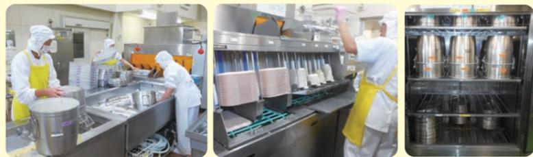
午後は各学校から戻ってきた食缶、バット、食器などをそれぞれ専用の洗浄機で洗浄します。食器やトレーはクラスの人数分に数えられ、高温の消毒保管機で乾燥、殺菌して翌日の給食に備えます。
