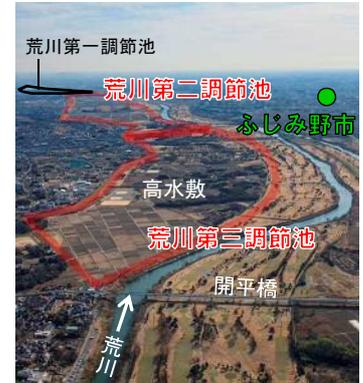
(注) 第二調節池・第三調節池では、第一調節池にある「彩湖」のような貯水池は造りません。(大きな洪水の時だけ、一時的に高水敷に水が流れ込むこととなります。)
