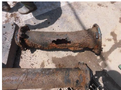
【老朽化により穴が開いた水道管】
