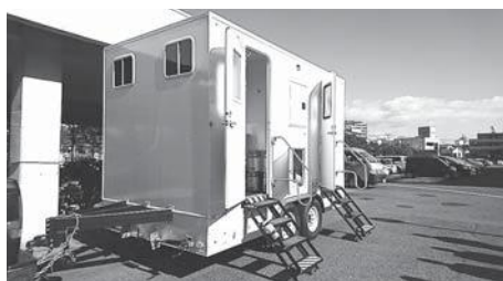
災害派遣トイレ
