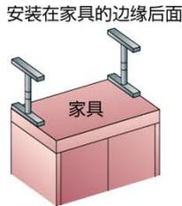
使用可调整高度的支撑天花板和家具的顶部安装填充缝隙装置。
