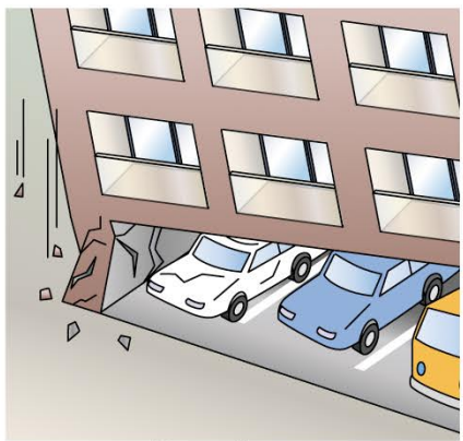
かい お マンションの1階が 押しつぶされたところ
